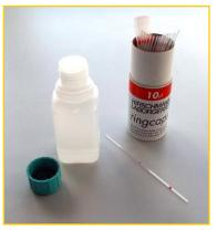
10 µL Probe (verdünnte Glycerinlösung) mit einer Kapillare entnehmen
