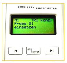
Küvette mit verdünnter Probe in das Photometer stellen und Schritte 7,8,9 der "TRI -Anleitung" wiederholen 3
