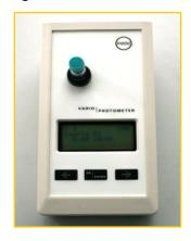
Küvette mit Probe in das Photometer stellen (Leerwert); Leerwert wird vom Gerät gespeichert
