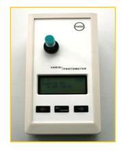
Küvette mit Probe in das Photometer stellen (Leerwert); Leerwert wird vom Gerät gespeichert
