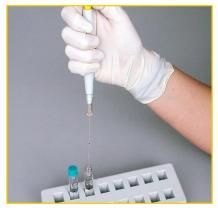
Die Probe mit dem Mikropipetter ausstoßen
